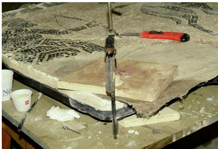
lavorazione. Il pannello di nido d'ape è stato contornato da "bordi di contenimento" di uno spessore medio, calcolato in relazione allo spessore delle tessere della preparazione. In media tale spessore variava tra un pavimento e l'altro, da un minimo di 2,5 cm ad un massimo di 5 cm.
